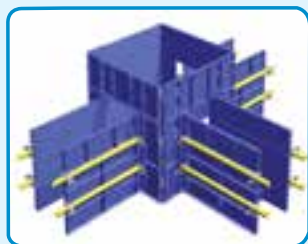
شکل ۳-۲۸-۳- قالب فلزی برای اجرای پی
